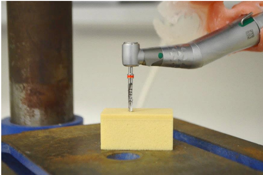
Abb. 1: Versuchsaufbau mit Kunststoffhalterung und Winkelstück. Der Bohrer trifft senkrecht auf den Knochenblock
