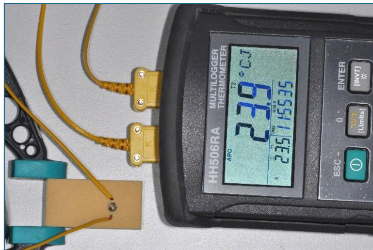
Abb. 6: Das Temperaturmessgerät (HH506ra – Omega) zeichnet die Temperatur beidseitig es Bohrers bzw. Implantates im Sekundentakt auf.
