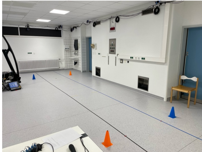
Abb. 4 Aufnahmebereich des Vicon-Kamerasystemes durch Leuchtkegel abgesteckt
