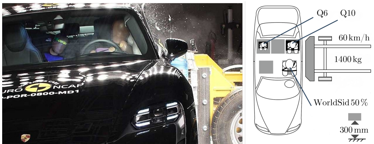
Abbildung 2.3: Seitenaufprall Porsche Taycan und zugehöriger Versuchsaufbau, nach [EuroNCAP] und [Reu25, S. 26]
