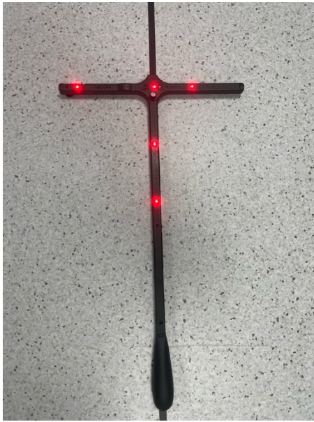
Abbildung 7: "Calibration wand" für die Kalibrierung der Kameras
