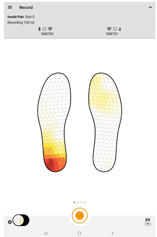
Abbildung 4: Screenshot der OpenGo Mobile App von Moticon während einer Gangmessung Die unterschiedliche Farbcodierung erlaubt eine visuelle Beurteilung der Druckverteilung auf dem Fuß. Eine dunklere Farbe steht dabei für eine höhere Krafteinwirkung. Die Messung wird über den orangenen Button in der unteren Bildschirmmitte gestartet.
