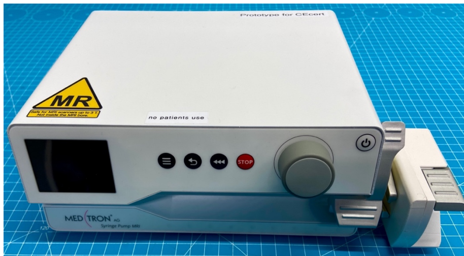
Abbildung 3: Prototyp MRT-taugliche Spritzenpumpe Accutron® Infuse MR der Firma Medtron AG.
