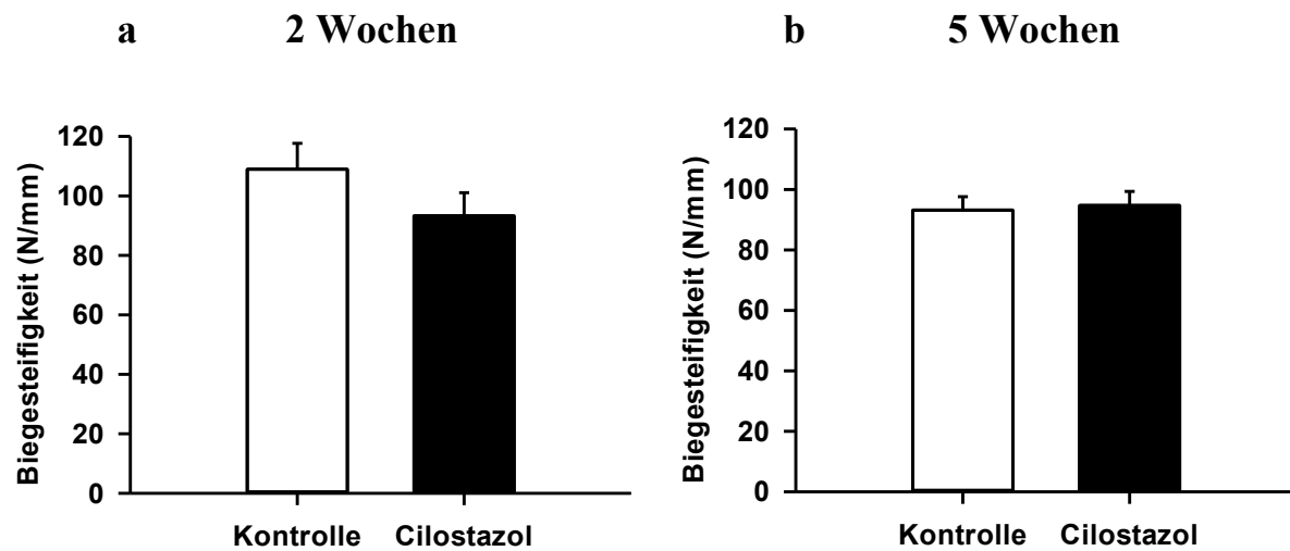
Abb. 54: Biegesteifigkeiten (N/mm) der nicht frakturierten kontralateralen Femora der Kontrolltiere (weiße Balken) und der mit Cilostazol behandelten Tiere (schwarze Balken) nach 2 (a) und 5 (b) Wochen Versuchszeit. Die Werte sind als Mittelwert \pm SEM angegeben.
