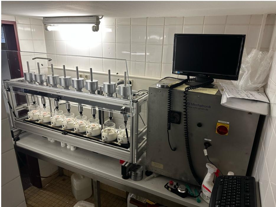
**Abbildung 7:** Kausimulator CS-4.8 SD-Mechatronik mit Computereinheit.
