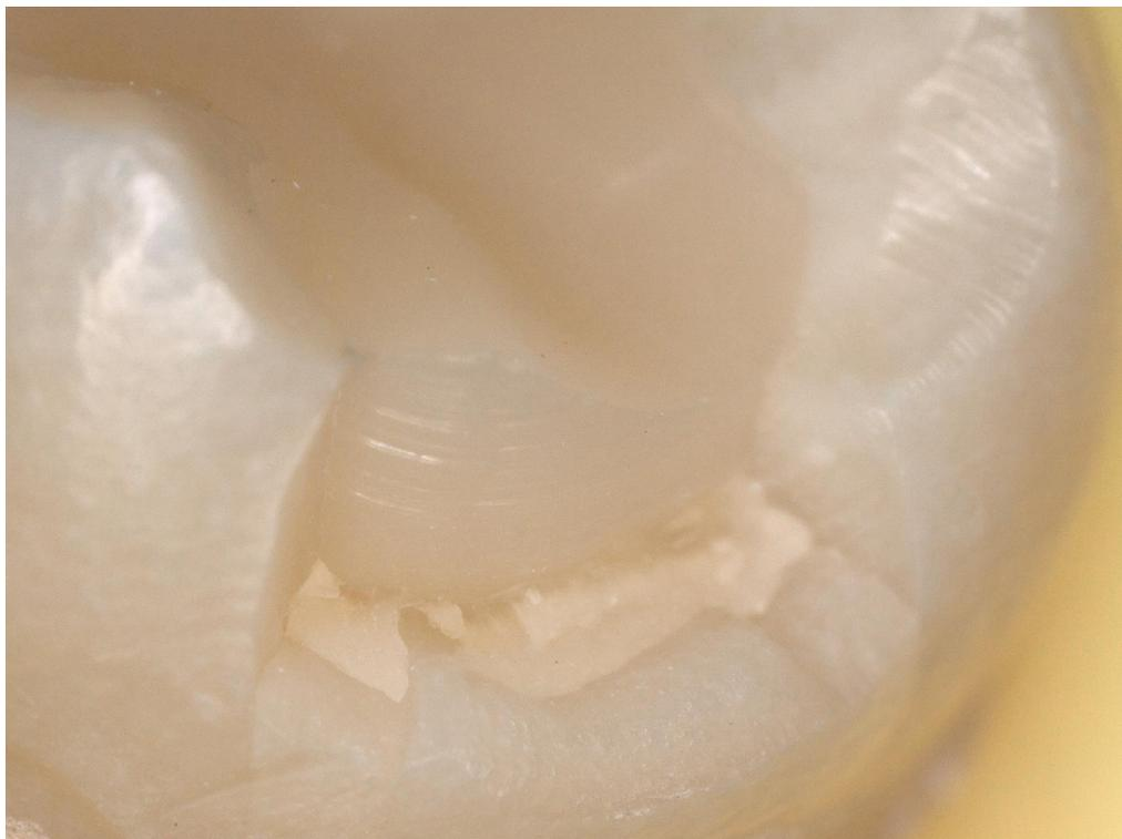
**Abbildung 55:** Schräg approximale Aufsicht auf den beschädigten Prüfkörper Nr.1 nach Verlust der approximalen Schmelzwand (Vertise™ Flow).
