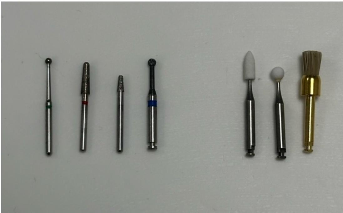
**Abbildung 4:** Eine Auswahl von verwendeten Schleif- und Polierinstrumenten (v.l.n.r Diamantkugel, Diamantkonus (lang), Diamantkonus (kurz), Rosenbohrer, Arkansas (Flamme), Arkansas (Kugel), Occlusbrush).
