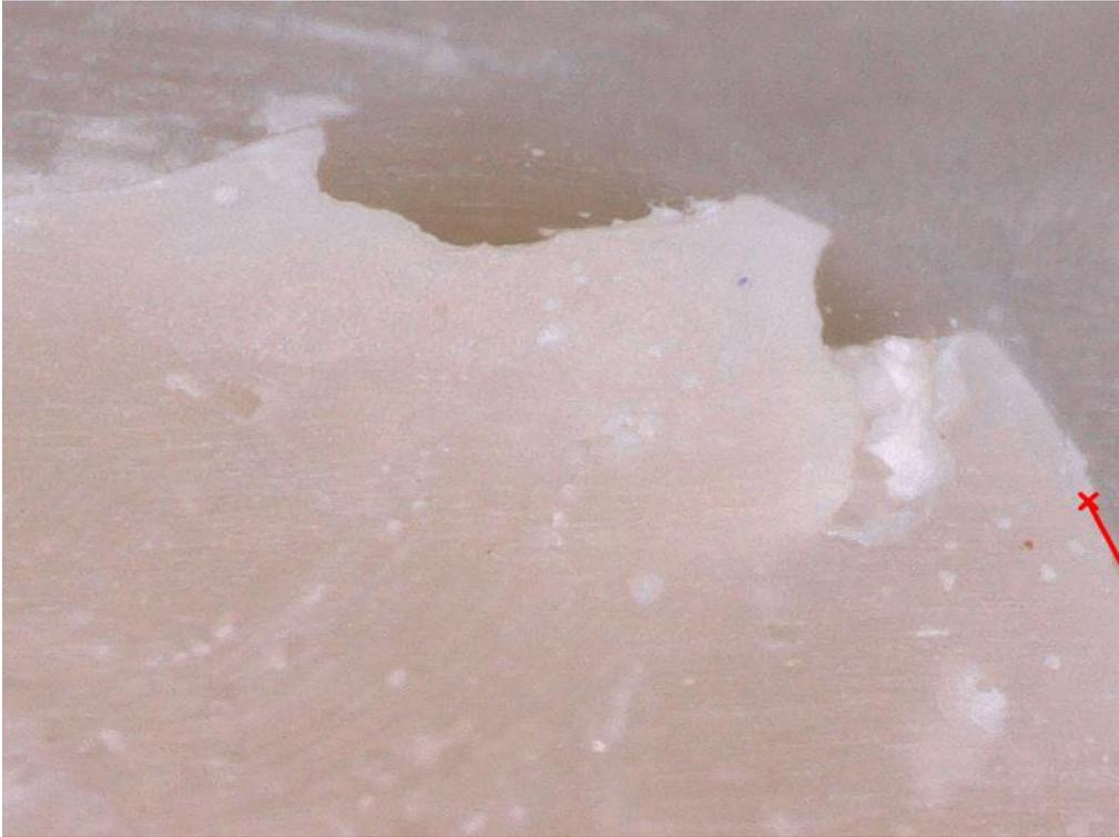
**Abbildung 51:** Vergrößerte Ansicht der Randaussprengung (Abbildung 39) von Prüfkörper Nr.3 nach der thermischen Wechselbelastung (Surefil one™ Gr. 1a).
