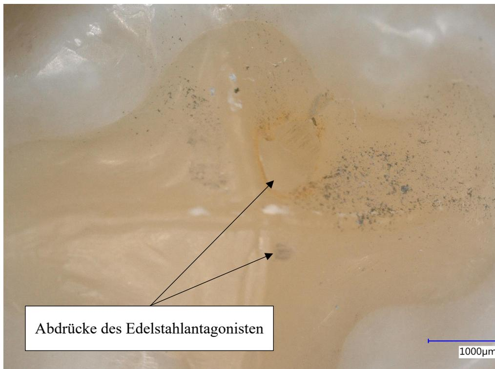
**Abbildung 57:** Vergrößerte Ansicht von Prüfkörper Nr.2 nach der thermomechanischen Wechselbelastung (Tetric® EvoCeram). Neben einer leichten oberflächlichen Verschmutzung (nicht von Bedeutung) sind die Abdrücke des Kausimulators auch hier abgezeichnet.
