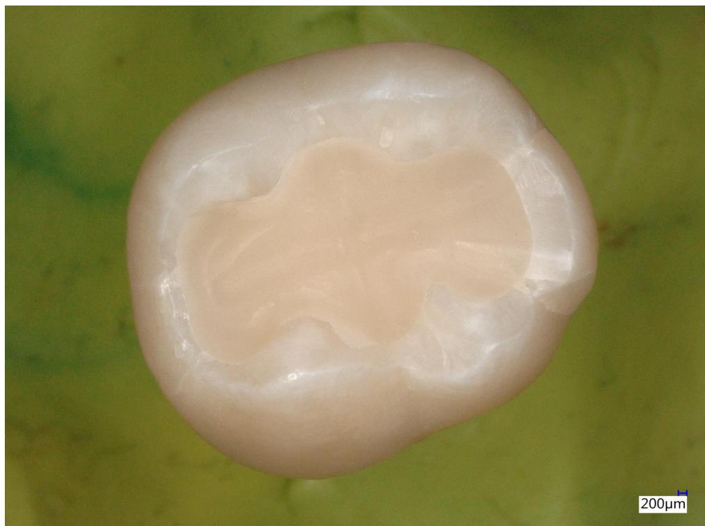
**Abbildung 44:** Primäraufnahme Prüfkörper Nr.1 nach der thermischen Wechselbelastung (Vertise™ Flow).
