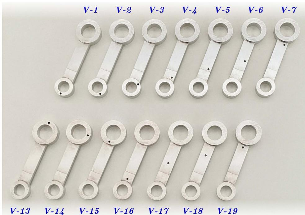
**Abb. 5.10:** Fotoaufnahme der 14 realen Validierpleuel V-1 bis V-7 und V-13 bis V-19 mit je einem Durchgangsbohrungs-Defekt in der finalen Größe von 3 mm
