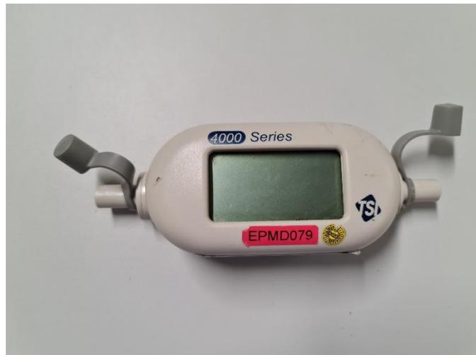
**Abbildung 7: Darstellung des eingesetzten Massendurchflussmessers.**
