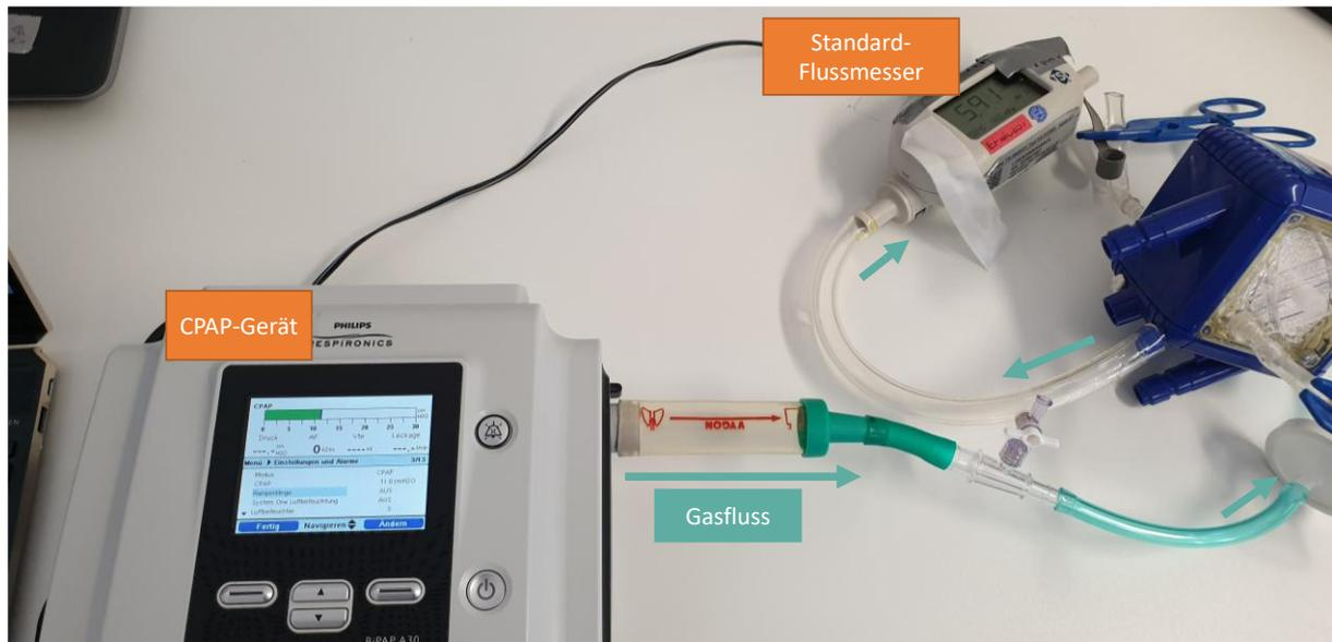
**Abbildung 10: Versuchsaufbau zur Bestimmung des Stromverbrauchs einer Turbine. Der Gasfluss wurde mit einem CPAP-Gerät erzeugt und über den Oxygenator zum Standardflussmesser geleitet. Das CPAP-Gerät wurde an eine Steckdose mit Stromverbrauchszähler angeschlossen.**
