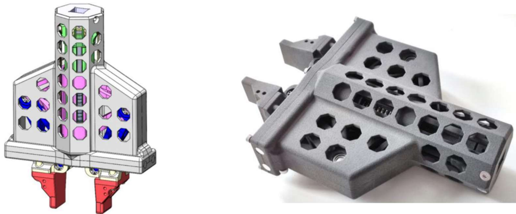
Abbildung 3: CAD-Konstruktion (links) und Foto (rechts) des ersten Prototyps eines Leichtbau Parallelgreifers mit FGL-Antrieb zur Anwendung mit kollaborativen Robotern.
