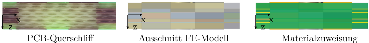
Abbildung 5.1: Ableitung des Submodells aus der Testplatine und Validierung des Lagenaufbaus im CAD-Modell auf Grundlage eines PCB-Querschliffs.
