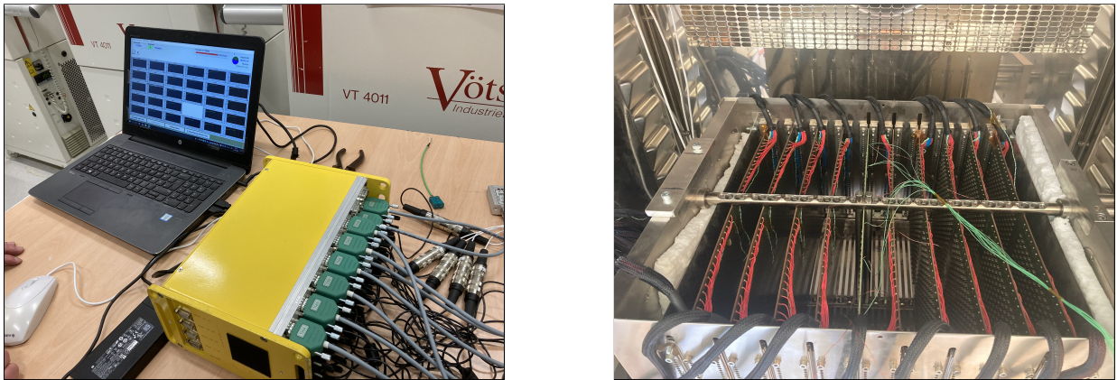
Abbildung 4.3: Messsystem (links) und eingebaute Platinen mit DMS (rechts).
