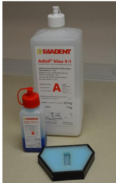
Abb. 2: Dubliersilikon und Silikonform zur Herstellung identischer Kunststoffblöcke
