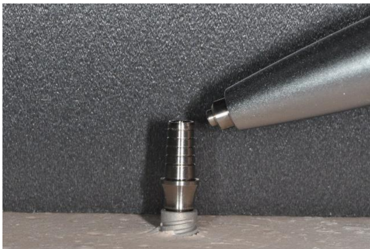
Abb. 14: Periotest an Prüfkörper
