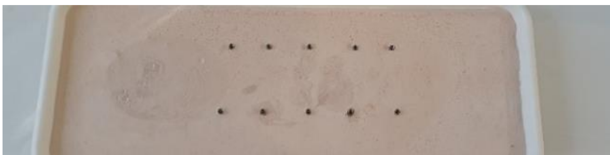
Abb. 12: Intakte Originalimplantate in Gips eingebettet
