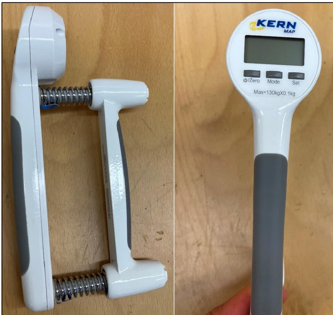
Abbildung 4: Handgriffkraftmesser (KernMap DHD-1 Hand Dynamometer, KERN & SOHN GmbH) Quelle: Eigene Abbildung (SAUTER, 2022)
