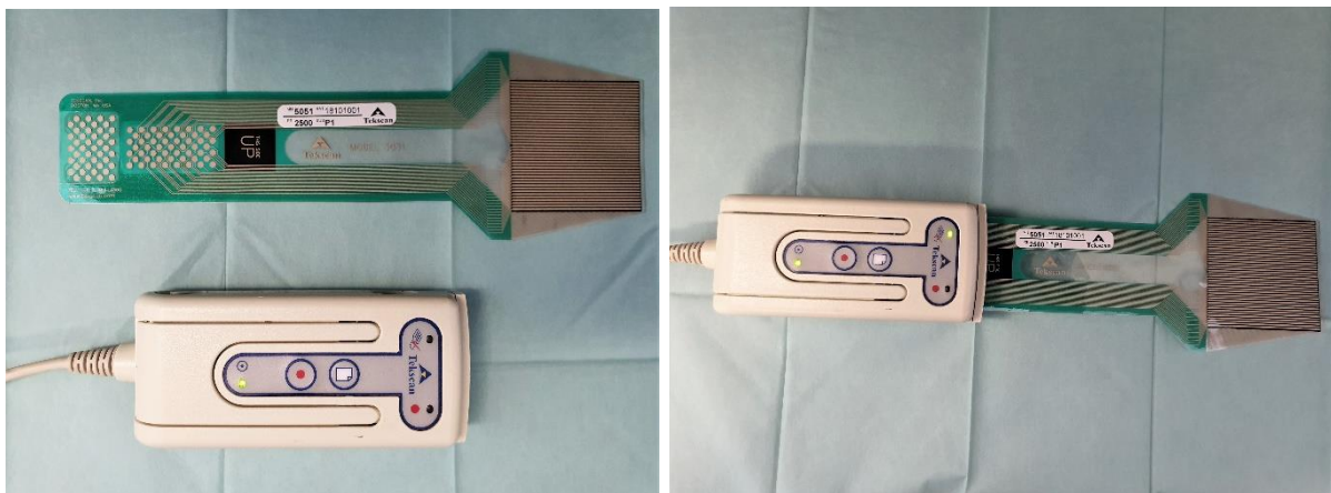
Abbildung 7: Tekscan Evolution Handle und Tekscan Sensor Folie vom Modell 5051
