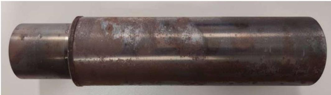
*Abbildung 7: Vergüteter Rundstahl bei einer Anlasstemperatur von  $300 \text{ °C}$  nach dem Schruppdrehen mit Korrosion hervorgerufen durch lange Lagerung.*
