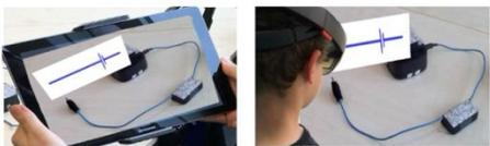
Display-basierte (links) und Smartglasses-AR-Anwendung (rechts) zur Echtzeit-Visualisierung von Schaltsymbolen für die Primarstufe
