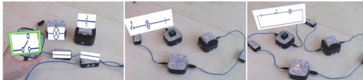
**Abb. 2:** AR-Lehr-Lern-Tool zur Echtzeit-Visualisierung von Schaltsymboliken aus der Sicht der AR-Brille bzw. aus der Kamerasicht eines Display-Geräts. Links: Symbole einzelner Bauteile und farbliche Hervorhebung bei Berührung. Mitte: Schaltskizze einer offenen Schaltung. Rechts: Schaltskizze einer geschlossenen Schaltung (Lauer et al. 2022).
