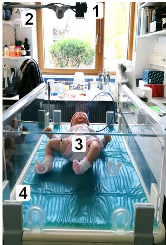
Abbildung 52: Infant Dummy: Messreihe 1 mit dem LD10c-1 (1) VitaSense-Sensor (2) Ständer (3) Infant Dummy LD10c-1 (4) Wärmebett.
