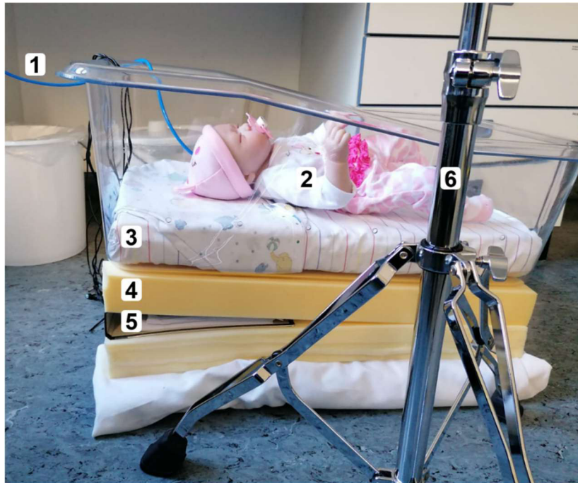
Abbildung 54: Infant Dummy: Messreihe 4 mit dem LD10c-2 (1) Kabel des Steuergeräts (2) Infant Dummy LD10c-2 (3) Wanne des Säuglingbettes (4) Schaumstoffmatten (5) Ordner (6) Ständer.
