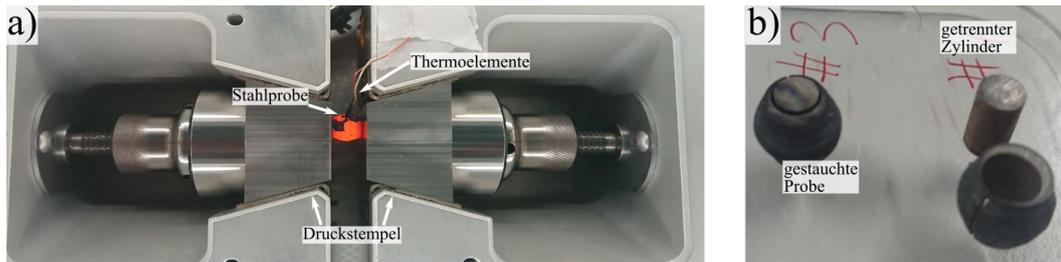
Abbildung 2.3: Walzsimulationen im Warmumformsimulator Gleeble. a) Beispiel einer Warmumformung einer zylindrischen Probe (nicht in vorliegender Arbeit verwendeter Aufbau). b) Weiterbearbeitung der Proben nach der Warmumformung zu zylindrischen Proben für die elektrische Widerstandsmessung, hier zur Verbildlichung durch Funkenerosionsdrahtschneiden dargestellt. Proben wurden durch Zerspansen in der Drehmaschine auf Endmaß gebracht.
