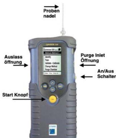
Abbildung 3-6 Aufbau der Cyranose 320 (modifiziert nach [111])
