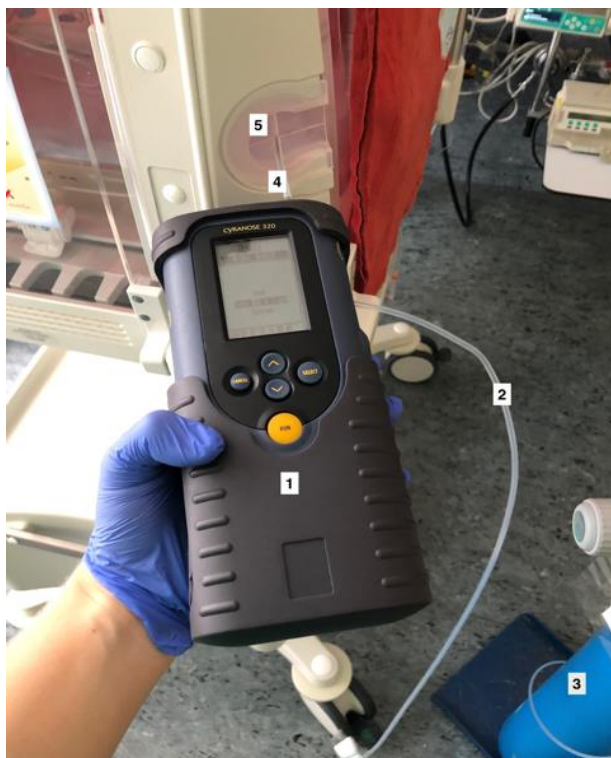
Abbildung 3-5 Messaufbau der Cyranose 320 auf Station
