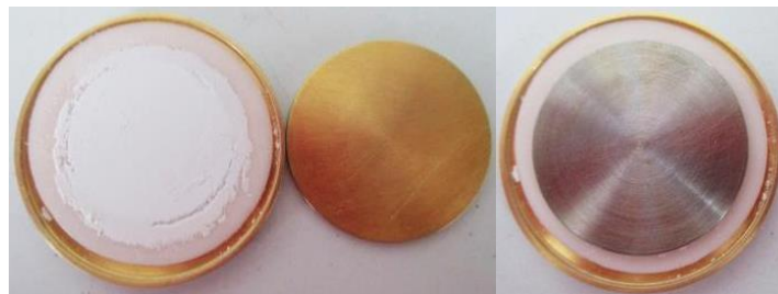
Abbildung 4.26: DES-Messzelle mit PTFE-Abstandshalter und beta-BEA Zeolithpulver links: offene Messzelle mit zwei Elektroden, rechts: geschlossene Messzelle
