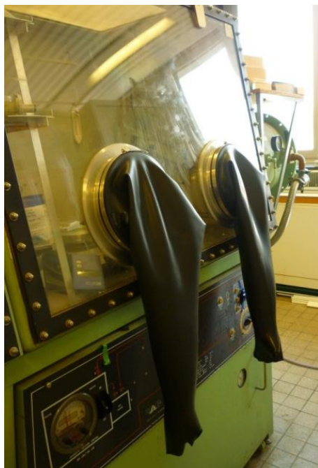
Abbildung 4.18: Hermetisch abgeschlossener Handschuhkasten mit Argon-Atmosphäre im Inneren
