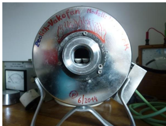
Abbildung 4.17: Offenes Stahlrohr mit Keramikschiffchen im Rohrofen [35]
