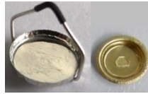
Abbildung 3.2: Verwendete Tiegel: links: Platinkorb, rechts: goldbedampfter Al-Tiegel mit Probe
