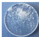
Abbildung 3.15: Pressling aus transparentem KBr und beta-BEA Zeolithpartikeln (weiß) [35]
