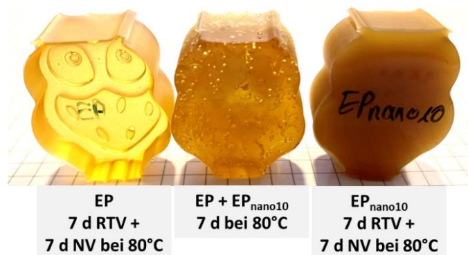
Abbildung 12.5: Links: Bulk-EP, 7 Tage Raumtemperaturvernetzung plus 7 Tage bei 80 °C nachvernetzt Mitte: Bulk-EP (vorderer, sichtbarer Teil), EP nano10 (hintere Ebene), direkt bei 80 °C vernetzt (7 d) Rechts: EP nano10 , 7 Tage Raumtemperaturvernetzung plus 7 Tage bei 80 °C nachvernetzt
