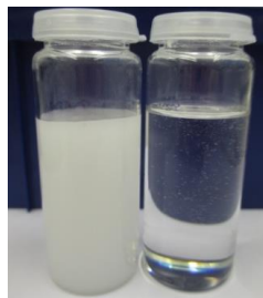
Abbildung 6.5: links: trübes, weißes D.E.R. 332 nach dem Walzen (ohne Zeolithpartikel) rechts: ungewalztes D.E.R. 332 (ohne Zeolithpartikel) nach 2-wöchiger Lagerung bei RT, (s. auch [35])
