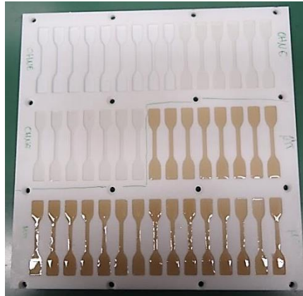
Abbildung 6.31: Gießformen in einer PTFE-Platte für Zugproben nach DIN53504-S2
