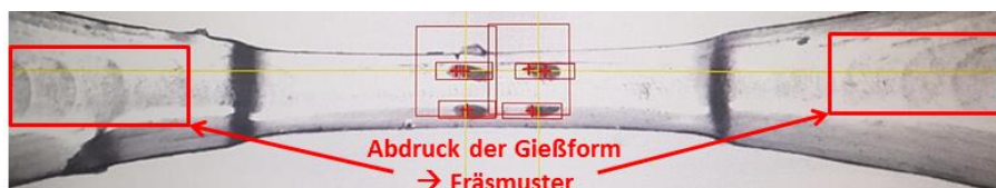
Abbildung 9.60: Deformation einer trockenen Bulk-EP Probe bei 35 °C (Screenshot in videoXtens)
