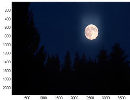
Abbildung 6.9.: Beispiel des Halo-Artefakts bei einem Direct-Lit Gerät. Entnommen aus [Sch17].
