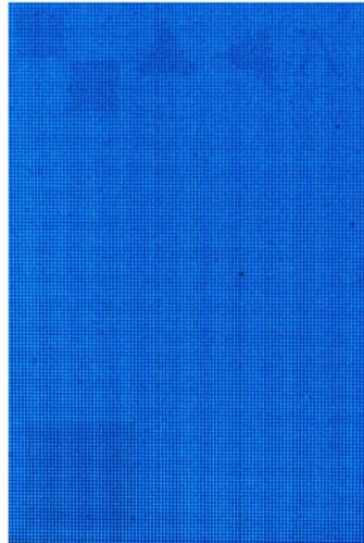
Abbildung 3.6.: Aufnahme eines *eingebrennten* OLED Displays. Gut erkennbar sind insbesondere die oberen Symbole durch eine verringerte Leuchtdichte. Entnommen aus [Vol17].
