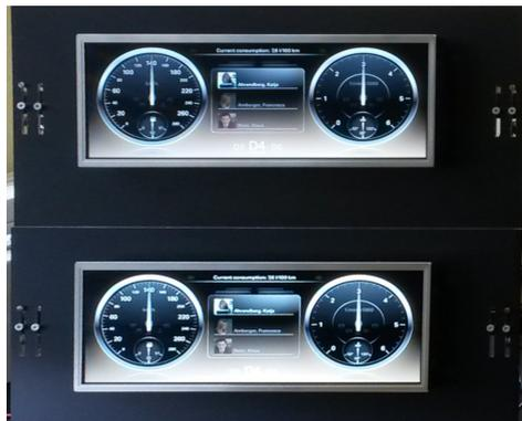
(a) Zwei Prototypendisplay, angesteuert durch ein einziges FPGA, jedoch mit autarken Global-Dimming Prozessoren.
