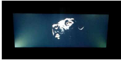
(a) All-On mit deutlich sichtbarem *Light-Leakage*. Die hellen Spots kommen durch mechanische Spannungen beim LC-Panel zustande.
