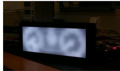
(d) 100 % LC-Transmission zur Anzeige der Hintergrundbeleuchtung eines HMI-Bildes beim Dimmen. Powersaving = 50 %.
