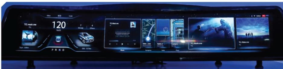
Abbildung 7.7.: Display mit einer Auflösung von  $1080 \times 7680$  Pixel und einer BLU mit 5096 Dimming Zonen. Hergestellt von *China Star Optoelectronics Technology*. Entnommen aus [Bla21].
