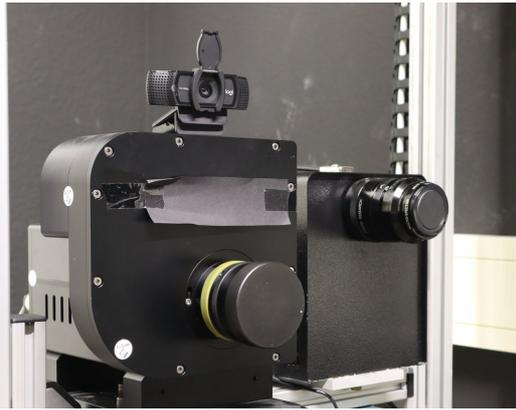
(a) Frontalansicht auf ELDIM (links) und Spektrometer (rechts). Eine Webcam wird verwendet, um aus dem Kontrollraum das Live-Bild zu sehen und die Ausrichtung zu vereinfachen.
