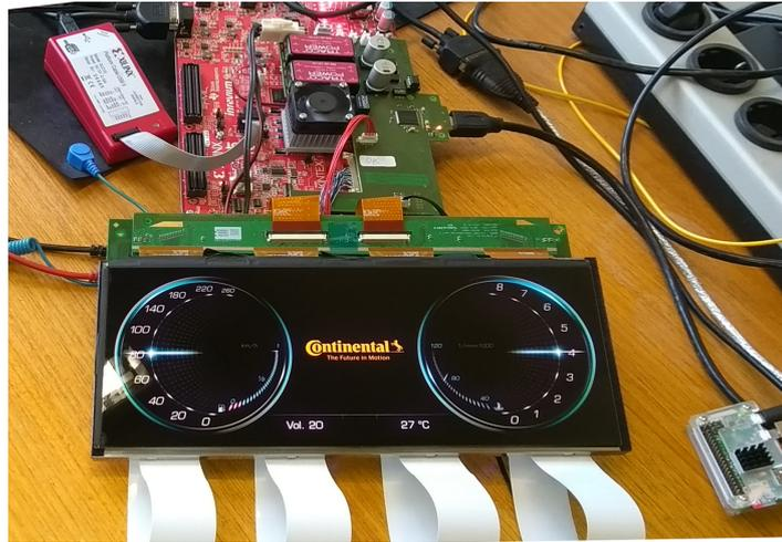
(a) Ein Prototyp basierend auf einem Inveium Board mit Xilinx Kintex 7 FPGA. Ein Raspberry Pi Zero dient hier als Bildquelle.
