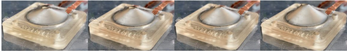
Abbildung 4-57: DE-Aktoren: COP-Aktor mit flexiblem und weichem Silikon-Dome als Vorspannmechanismus. Bewegung des Aktors bei angelegter Spannung.
