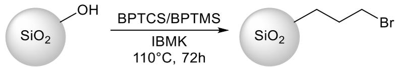
Abbildung 35: Reaktionsschema der Funktionalisierung von Silica-Nanopartikeln mit Bromopropyltrichlorsilan (BPTCS) und Bromopropyltrimethoxysilan (BPTMS).
