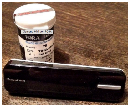
Abbildung 10: FORA Diamond Mini: Das in der Studie verwendete Blutzuckermessgerät (FORA Diamond Mini) verwendet die Glucose-Peroxidase-Reaktion zur Messung der Blutglucosekonzentration, Quelle: Gdanietz I et al.
