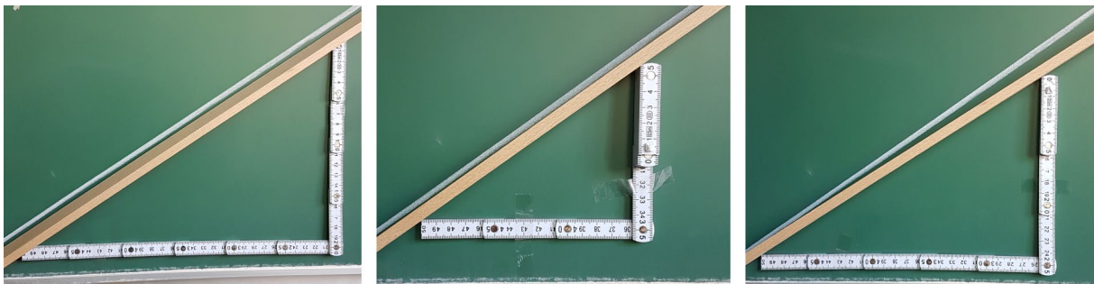
Abb. 77: Gebaute Rampen im Vergleich mit der vorgegebenen Linie
