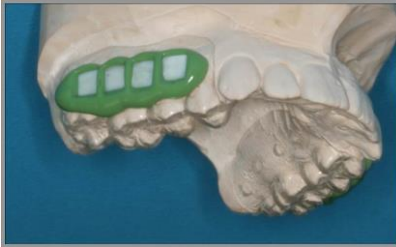
Abb. 3-2 Vorbereitete Prüfkörperträgerschiene. Vier SPK sind je Seite mit Polyvinylsiloxan so auf individuellen tiefgezogenen Schienen befestigt, dass die Schmelzfläche frei liegt und die Seitenflächen ohne überstehendes Befestigungsmaterial gefasst sind
