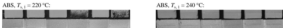
Abbildung 8-4: Bruchbilder (oben: Polymer-Fügeteil, unten: Aluminium-Fügeteil) der geprüften ABS-Aluminium-Zugscherproben mit verschiedenen Substrattemperaturen T_{s,1} .
