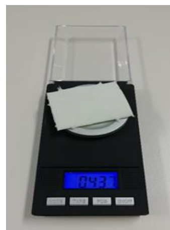
Abbildung 12: Bestimmung der Zellstofftupfersmasse mittels der Waage.
