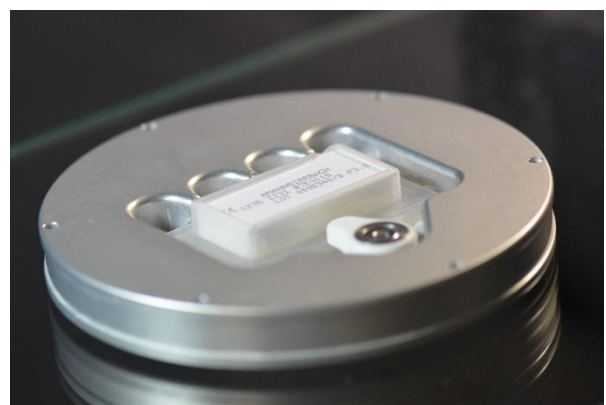
Abb. 10: Eingespannter ZrO 2 -Block für die Fräsung der OD- und MOD-Attachments
