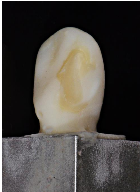
Abb.23: Adhäsiv-Rückstände an der OD-Kavität des Prüfkörpers Nr. 48
