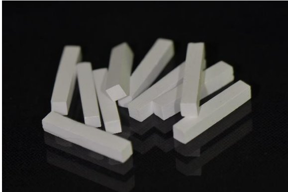
Abb. 7: Zugeschnittene Stäbchen als Attachments, vor dem Sintern
