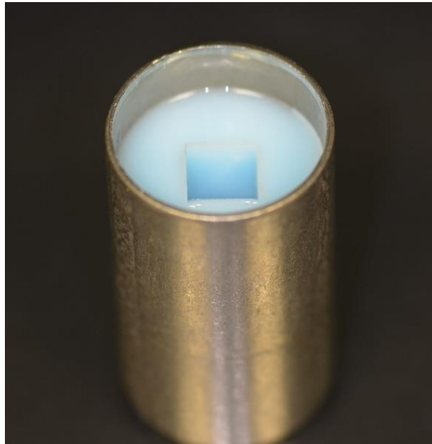
Abb. 6: Hergestellte Dublierform nach Entfernen des Vormodells
