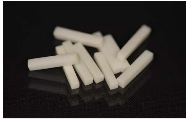
Abb. 8: Attachments nach dem Sintern, mit dem Ausmaß 2,5x 2,5x10mm
