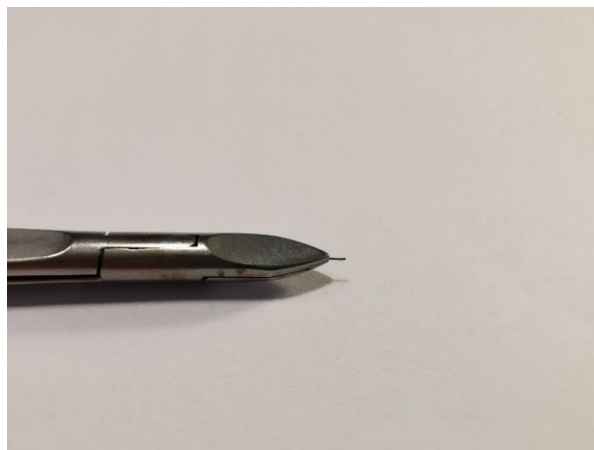
Abbildung 10: Eingespanntes Haar in Klingenbranchen.
