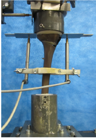
Abbildung 1: Versuchsaufbau mit Anordnung der Sensoren (links: lateraler Sensor, rechts: medialer Sensor, oben: horizontale Sensoren)
