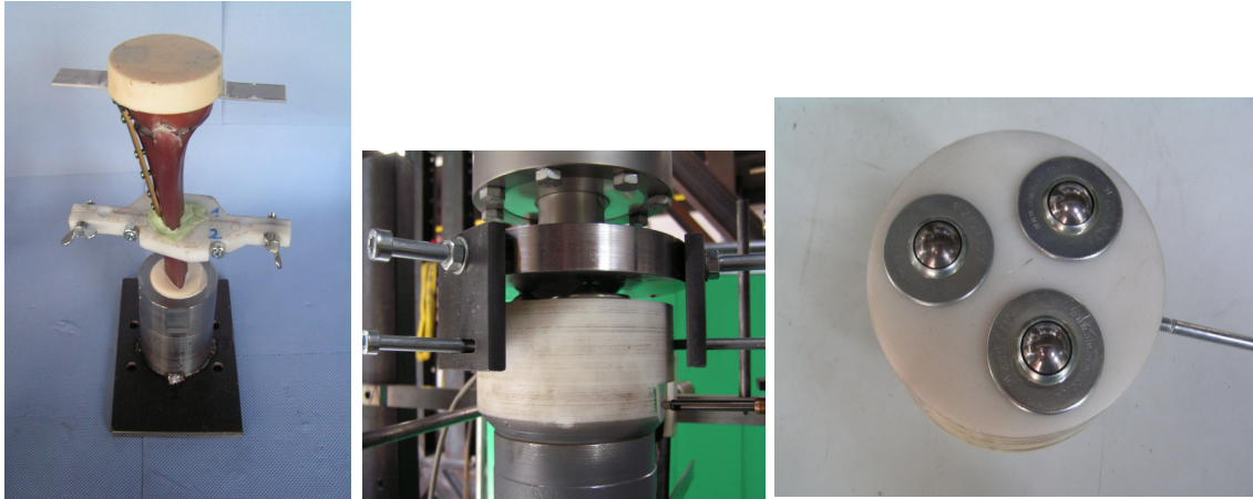
Abbildung 11: Fertiggestellter Prüfkörper (links); Horizontales Verschiebelager (Mitte); Kugellager zur Gewährleistung der Horizontalverschiebung zusätzlich mit Fließfett(Shell Retinax CS00) geschmiert (rechts)
