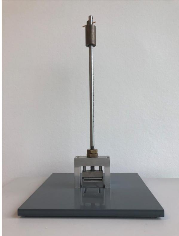
**Abbildung 11: Frakturvorrichtung.** Stumpfe Guillotine zur Frakturierung der Femora. (Quelle: Eigene Aufnahme)
