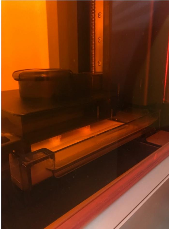
**Abbildung 5.7 Formlabs Form 3 SLA 3D-Drucker**
