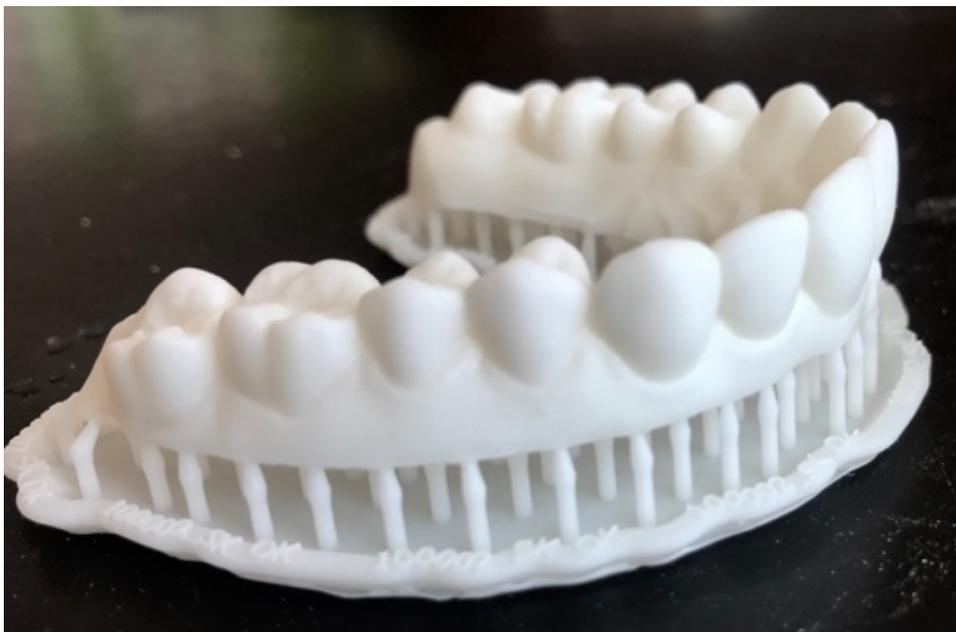
**Abbildung 5.9 Oberkieferkranz nach Beseitigung der unausgehärteten Harzablagerungen, vor Entfernung der Stützen**
