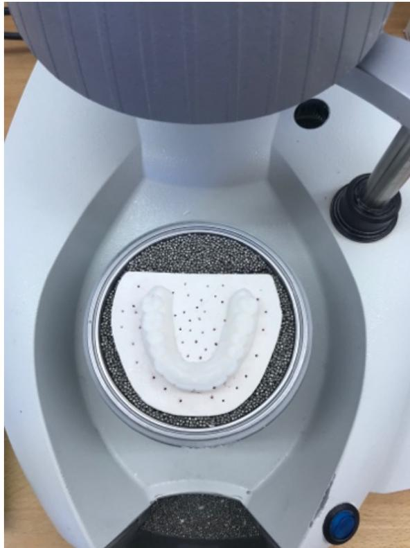
**Abbildung 5.10** Oberkieferkranz platziert im Tiefziehgerät Track-V
