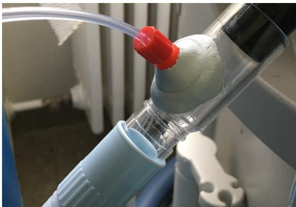
**Abbildung 8 T-Stück (Eigenkonstruktion des CBR)**
