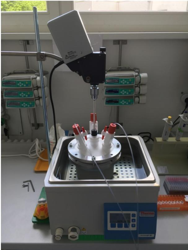
**Abbildung 24: Messaufbau der Pentanalkalibration**
