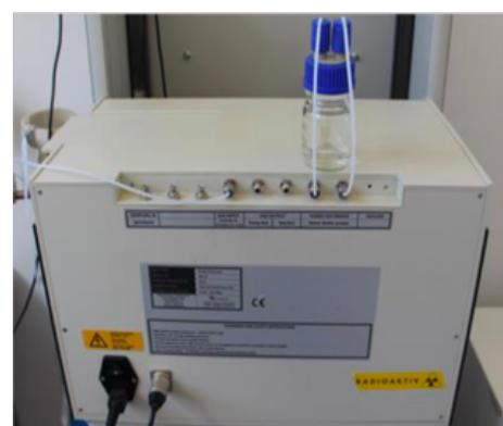
Abbildung 15: IMS vom Typ „Breath Discovery“ von hinten
