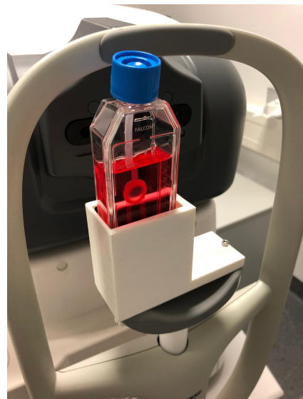
Abbildung 3.6: Befestigung der Zellkulturflasche mithilfe einer Halterung (orange) auf der Kinnstütze vor dem OCT (Beispiel Casia 2)
