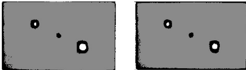
Abbildung 63: Hardspot-Klassifikation auf Basis der bisher verwendeten vier Merkmale D_{Zmax} , D_{Zmean} , D_{Zr} und V_{c_{dz}} und des bisher eingesetzten Hardspot-Klassifikators ohne eintrainierten Randbereich
