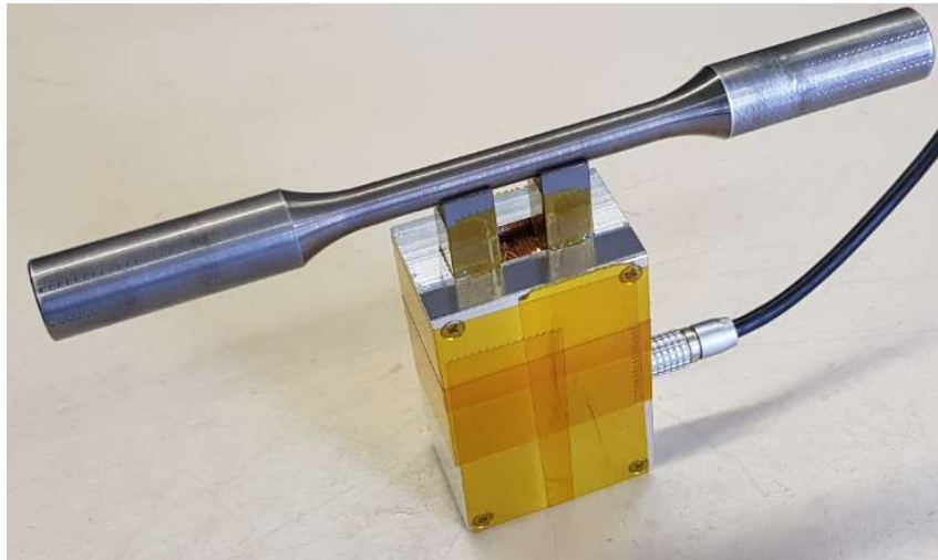
Abbildung 46: An Probendurchmesser adaptierter 3MA-X8-Sensor
