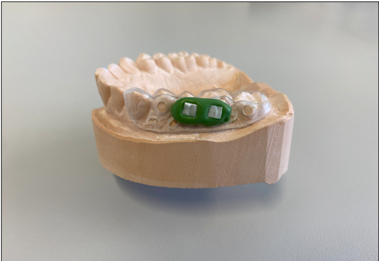
Abb. 2: Modell mit individueller Trageschiene und montierten Prüfkörpern
