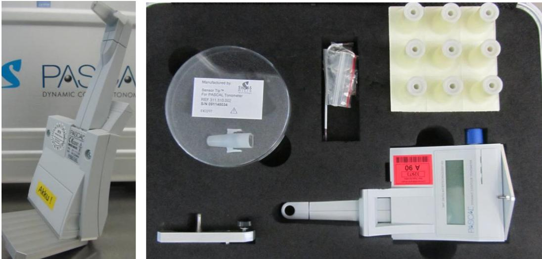
Abbildung 7: Das DCT inklusive Zubehöres (rechts) und montiert angeschraubt auf die Metallplatte zur Anbringung an die Spaltlampe (links).
