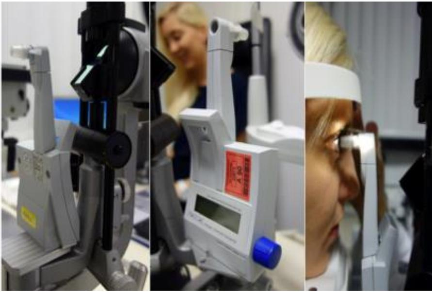
Abbildung 14: Spaltlampenmontiertes DCT mit Einmal-Silikonüberzug.
