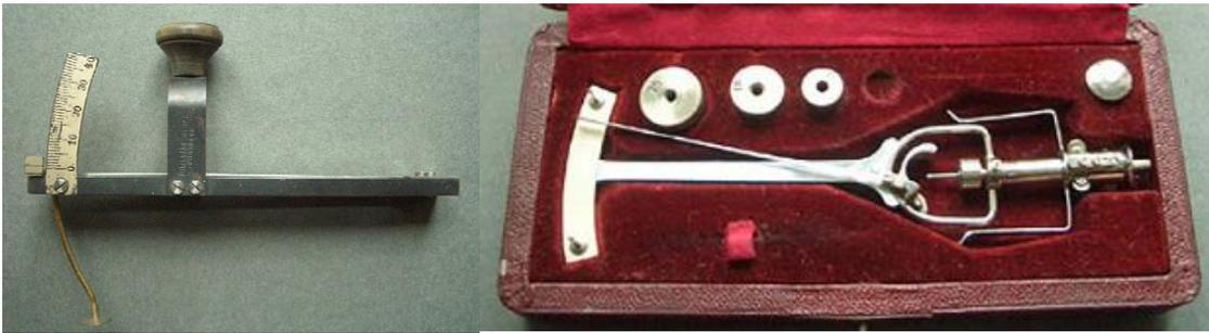
Abbildung 2: Ficks handgehaltenes Tonometer (links) und ein Schiøtz-Eindrucktonometer aus dem Jahre 1905 (rechts) [52].
