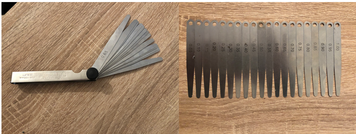
Abb. 6: Fühlerlehre. a Zusammengesetzt und b in Einzelteilen
