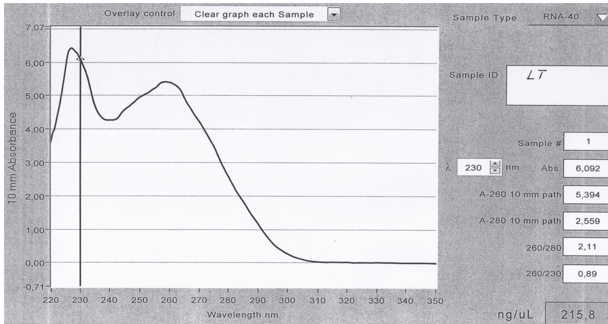
Abbildung 24: Originaldarstellung eines Ergebnisses der RNA-Quantifizierung mittels NanoDrop-Spektrophotometer. In einigen Vorversuchen zeigte sich im Rahmen der RNA-Quantifizierung mittels Spektrophotometer ein zweigipfliger Kurvenverlauf mit auffälligem Peak bei einer Wellenlänge von 230 nm, welcher am ehesten durch eine Verunreinigung der Probe durch Guanidinisothiocyanat hervorgerufen wurde. Dies resultierte in einem A_{260/230} -Quotienten, der deutlich unterhalb des unteren Referenzbereichs von 1,8 lag.
