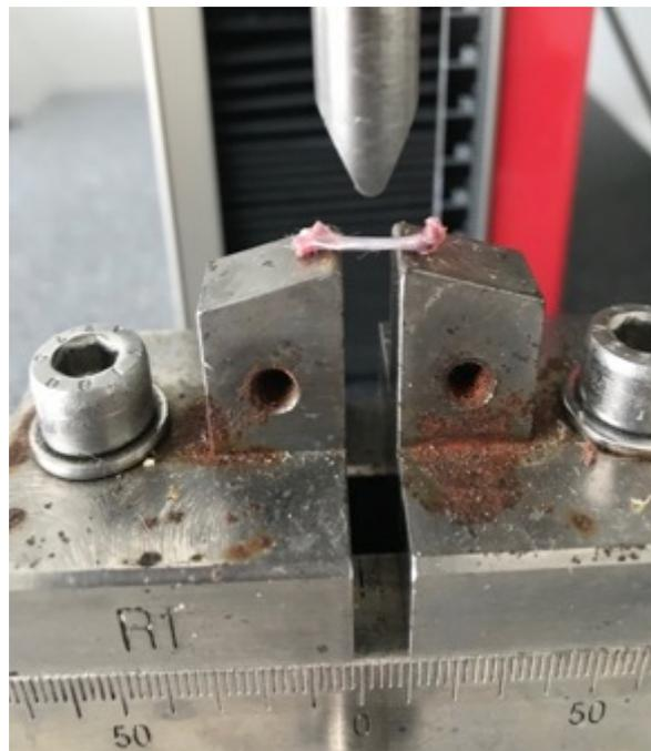
**Abb. 17:** Positionierung des Femurs in der 3-Punkt-Biege-Einrichtung.
