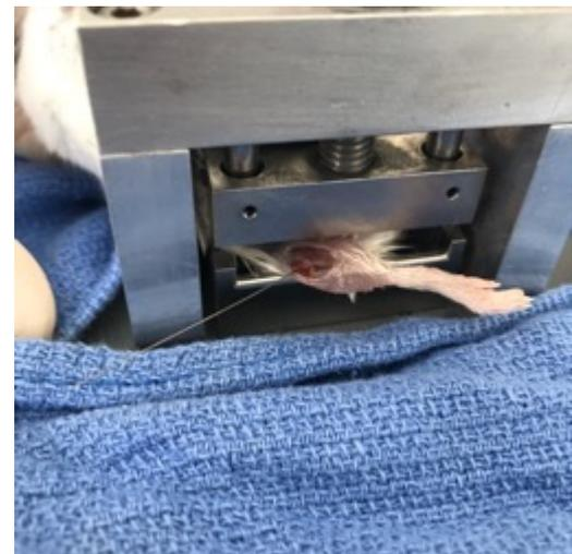
**Abb. 10:** Erzeugung der Fraktur mittels 3-Punkt-Biege-Vorrichtung.
