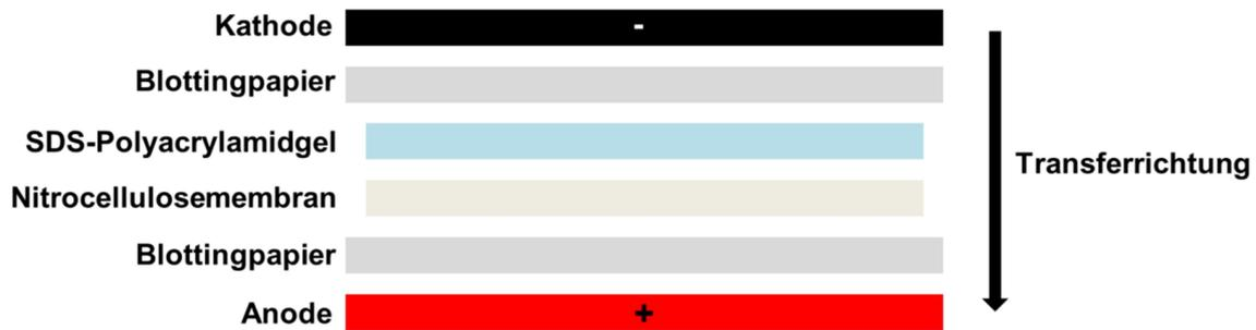
**Abbildung 10: Schematischer Aufbau des elektrophoretischen Transfers der im SDS-Gel aufgetrennten Proteine auf die Nitrocellulosemembran im Trans Blot Turbo Transfer-System der Firma Bio-Rad.** Die Proteine werden durch ihre vom SDS induzierte negative Ladung in Richtung der Anode (+) vom SDS-Gel auf die Nitrocellulosemembran transferiert. Die Transferrichtung ist durch den schwarzen Pfeil gekennzeichnet.
