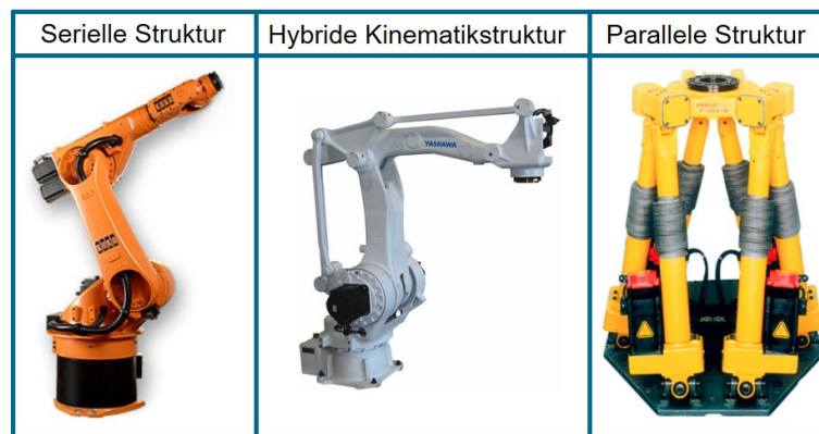
ABBILDUNG 3.1: Kinematische Strukturen des Industrieroboters: seriell (links [38]), hybrid (mittig [39]) und parallel (rechts [40])
