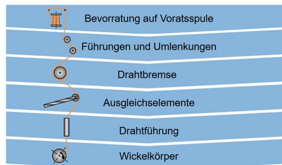
ABBILDUNG 2.5: Allgemeine Struktur des Wickelprozess [28]
