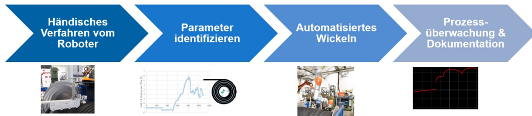
ABBILDUNG 4.16: Planung zur Prozessdurchführung
