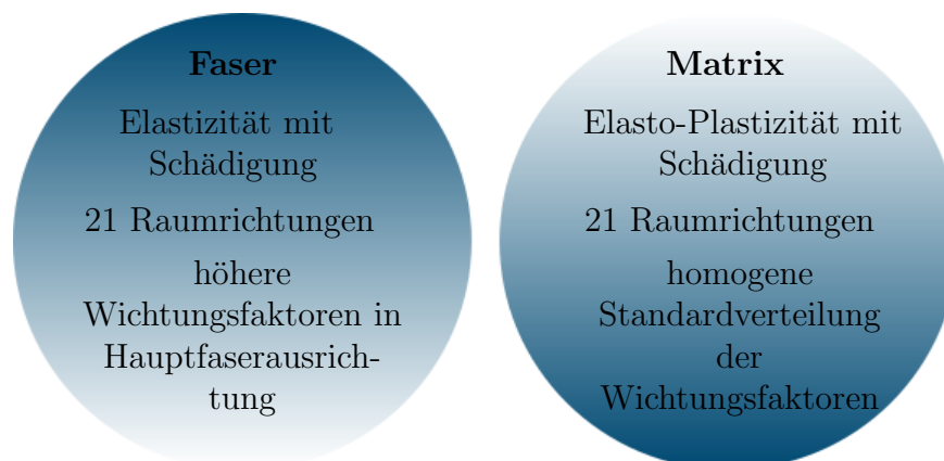
Abbildung 4.17: Microsphere-Modellierung mit 2 Sphären zur Beschreibung des Verbundmaterials
