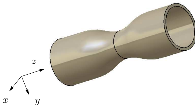
Abbildung 4.25: Torsionsprobe des Verbundmaterials
