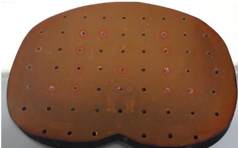
Abbildung 12: Bestückung von Schicht 19 im Oberbauchmuster. Zu sehen ist die Verpackung der TLDs in den Plastiktütchen.
