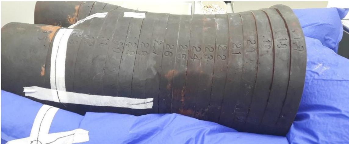
Abbildung 9: Lagerung des Aldersonphantoms in Vakuummatratze. Durch die Fixierung wurde eine sichere Lagerung des Phantoms auch bei Entnahme einzelner Schichten zum Bestücken mit TLDs sichergestellt.
