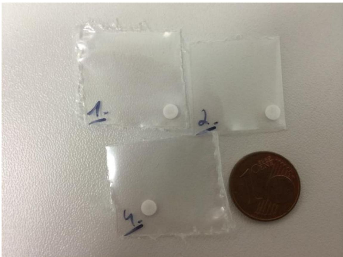
Abbildung 4: Thermolumineszenzdosimeter. Zum Größenvergleich ein 1-Cent-Stück. Bild von Katharina Speicher
