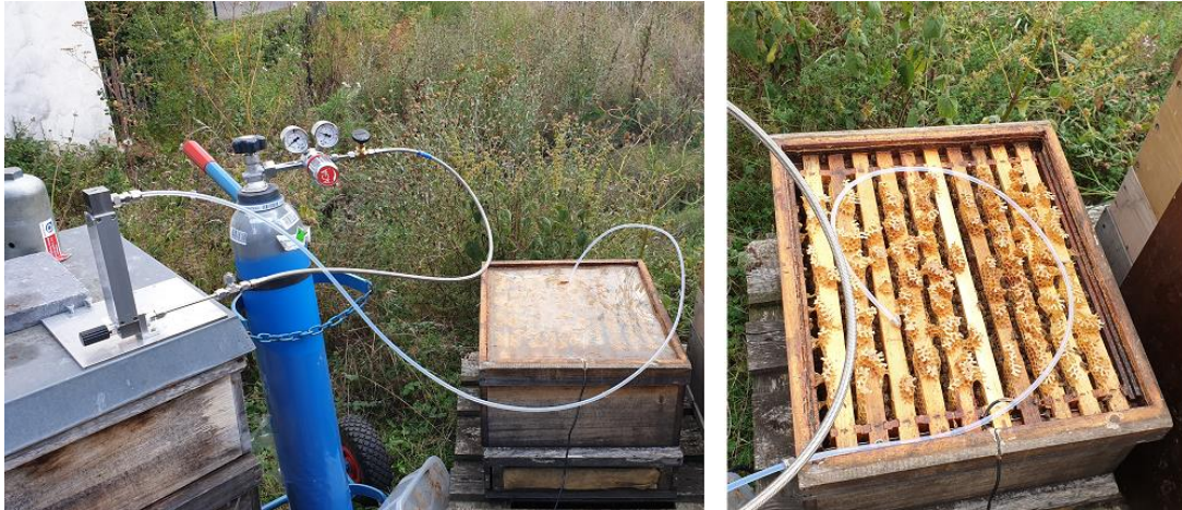
Abb. 6.28 Experimenteller Aufbau zum Testen, ob Bienen \text{CO}_2 aktiv regulieren. Links: \text{CO}_2 -Flasche. Rechts: \text{CO}_2 wird über einen Schlauch in den Bienenkorb geführt.
