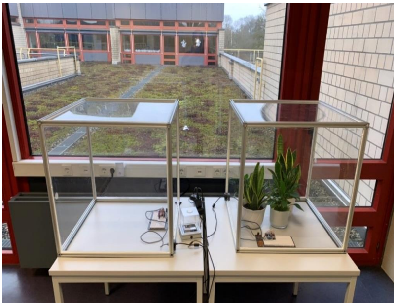
Abb. 6.34 Versuchsaufbau zur Messung des Einflusses von Pflanzen auf die Luftqualität. Links: Leere Kontrollkammer. Rechts: Messkammer mit verschiedenen Pflanzenarten.
