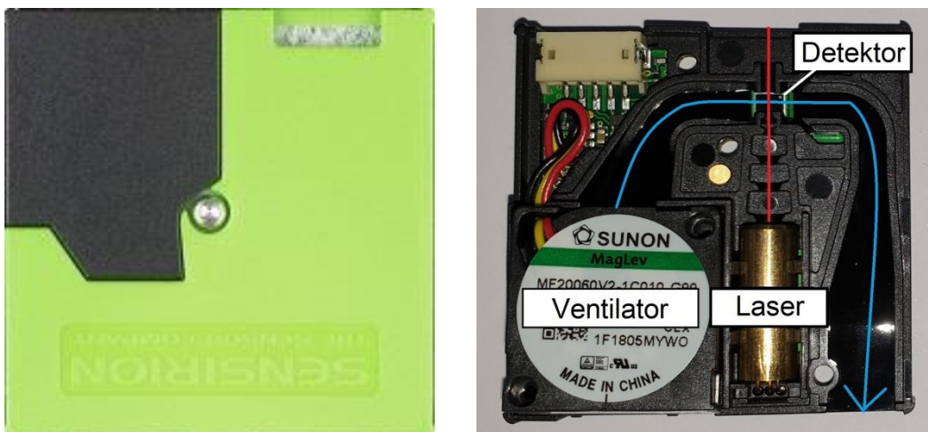
Abb. 4.19 Low-cost-Feinstaubsensor SPS30 von Sensirion. Links: geschlossener Sensor. Rechts: geöffneter Sensor
