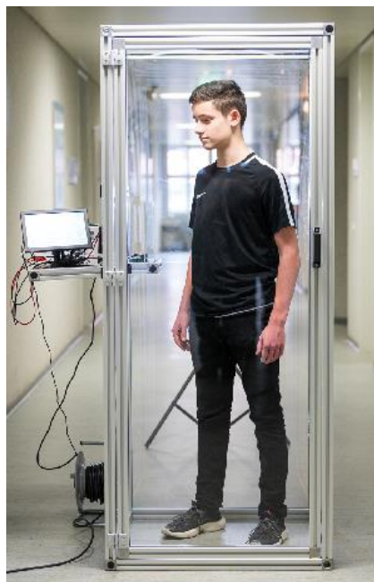
Abb. 5 Begehbare Messkammer zur Untersuchung von CO 2 - und TVOC-Ausgasungen des Menschen.
