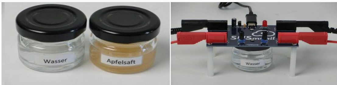
Abb. 5.14 Messproben und Anschluss an die Platine. Die Heizspannung für den Gassensor wird über ein USB-Netzteil bereitgestellt und kann durch Potentiometer manuell variiert und mit einem zweiten Multimeter erfasst werden.
