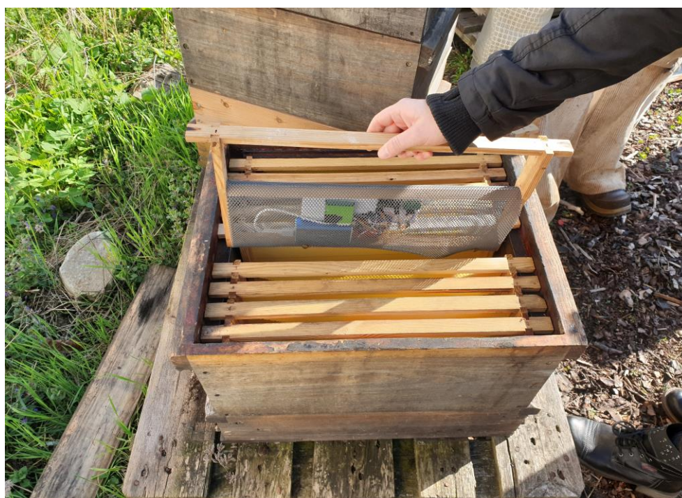
Abb. 6.20 Befestigung der verwendeten Sensoren an einem Bienenrahmen. Der Messaufbau ist durch ein luftdurchlässiges Drahtgeflecht geschützt.
