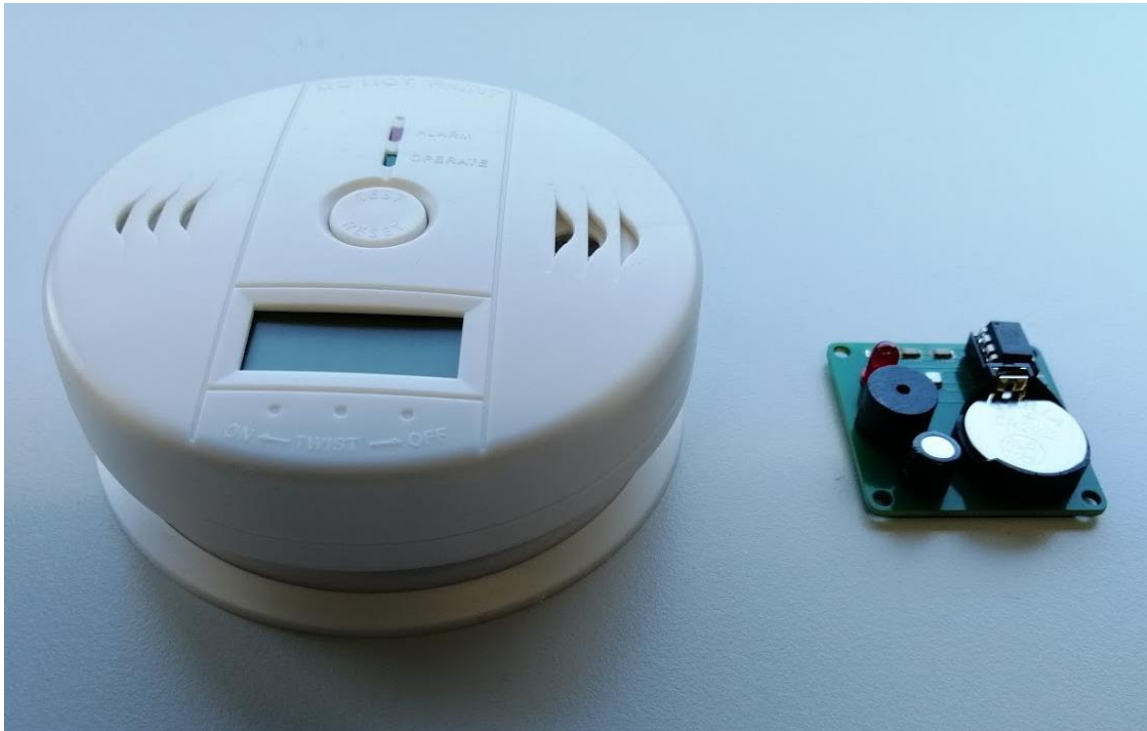
Abb. 11: Mein Portabler Warner neben einem stationären CO-Warner.
