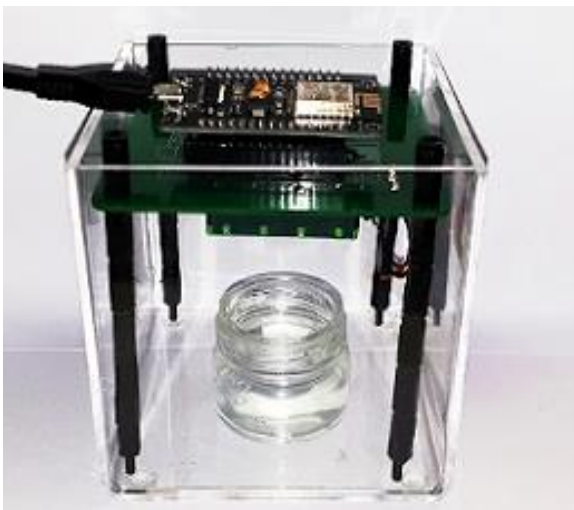
Abb. 3 Versuchsaufbau zur Messung der Ethanol-Konzentration von 5 Lösungen.
