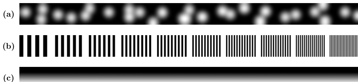
Abb. 6.2: Störungsfreie Prüfsituation Simulation 1 und 2, die NETD ist an dieser Stelle noch nicht sichtbar. a) Wärmeverteilung T , b) Materialverteilung \varepsilon , c) Reflexionen T_a
