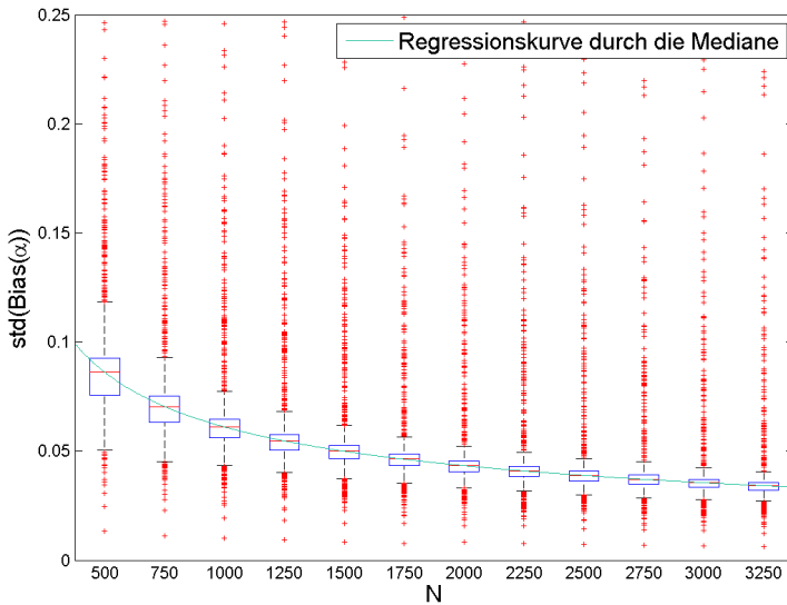
Abbildung 4.4: Entwicklung der Standardabweichung des Schätzfehlers von \alpha bei der TCD gemäß 4.5.2. Die Box kennzeichnet die Grenzen des oberen und des unteren Quartils. Der rote Strich innerhalb der Box markiert den Median der Datenpunkte. Die Endpunkte der Whiskers geben die Lage des größten bzw. kleinsten Datenpunkts an, der maximal um den 1,5-fachen Interquartilsabstand oberhalb bzw. unterhalb der Grenze des oberen bzw. unteren Quartils liegt.
