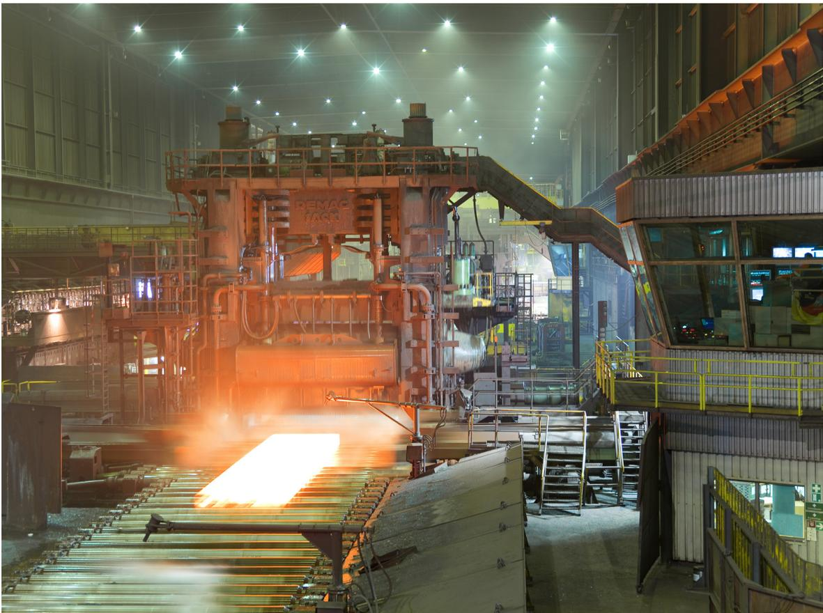
Abbildung 1.1: Erhitzte Stahlplatte vor dem Walzgerüst, danach erfolgt die (ACC) Kühlung aus der Walzhitze, © Dillinger
