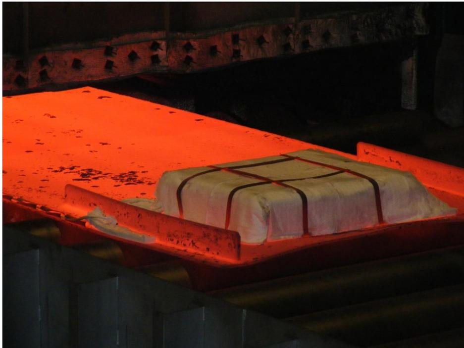
Abbildung 1.6: Versuchsblech (vor der Kühlung) zur Generierung von realen Messdaten, Datenlogger mit Schutz gegen die Hitze angebracht, © Dillinger
